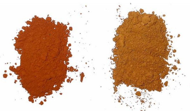
Рис. 1. Нано- и микроразмерные образцы никель-цинкового феррита ( \text{Ni}_{0,25}\text{Zn}_{0,75}\text{Fe}_2\text{O}_4 ) соответственно
